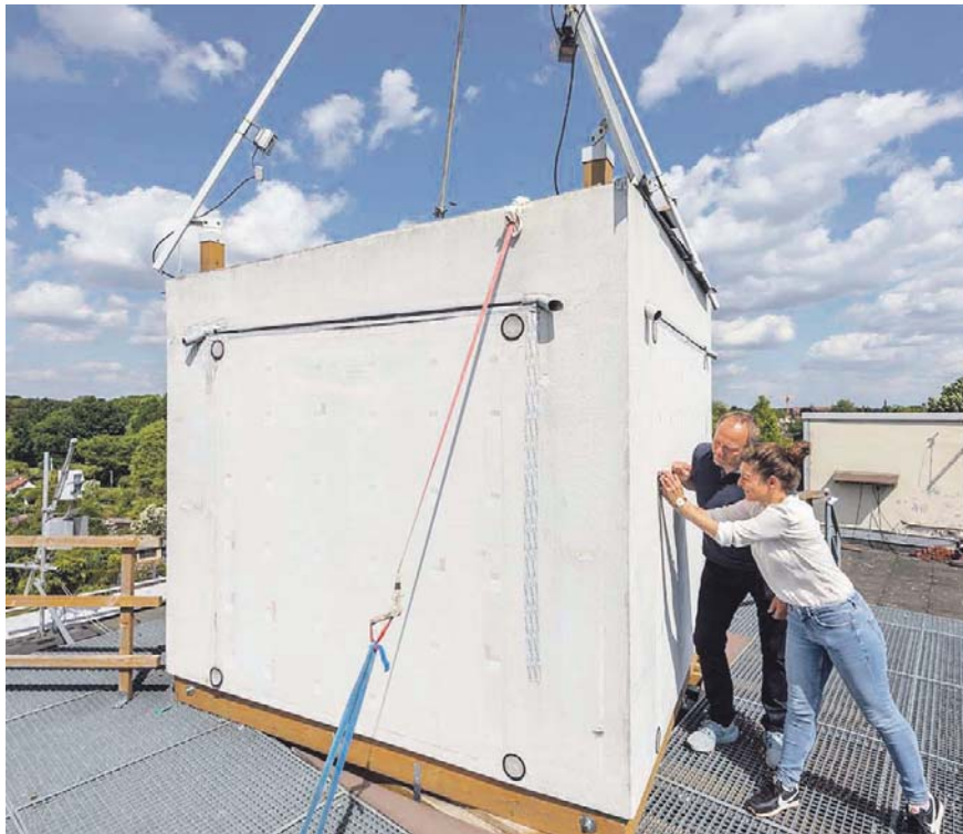
Eindruck vom Teststand der Leibniz Uni Hannover. Hier überwachen und monitoren die Fachleute die Bildung von Oberflächenfeuchte und -temperaturen sowie die Bewuchsentwicklung. Foto: Leibniz Universität Hannover, FBG_C. Bierwagen
