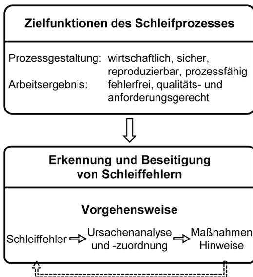
Bild 1. Schleifprozess, Fehlererkennung und Fehlerbeseitigung
