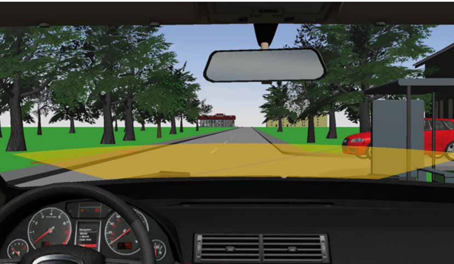
Abb. 4: 3D-Simulation zur Bewertung des Schutzpotenzials von Fahrzeugumfeldsensorik.
