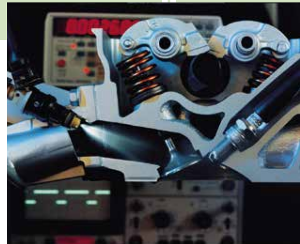
Benzinmotor (Schnittbild) mit Saugrohreinspritzung: offenes Ventil (links) und Zündkerze.
