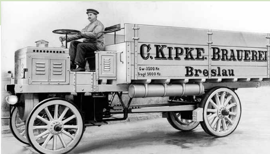
Daimler Phönix, erster Motor-Lastwagen mit serienmäßiger Bosch-Magnetzündung, 1898: zehn PS, eisenbereifte Räder mit Holzklotz-Bremsen.
