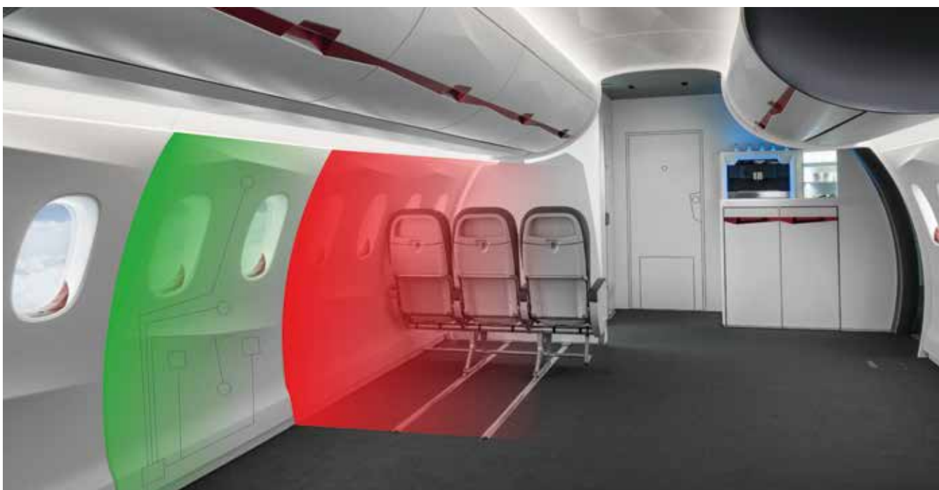
Schallpegelreduktion vor einem aktiven Lining in der Flugzeugkabine.
