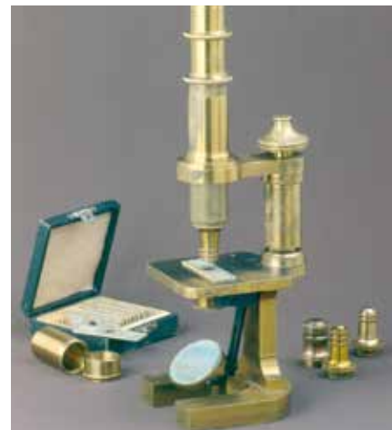
Erste Generation zusammengesetzter Mikroskope (1850) mit hufeisenförmigem Fuß.
