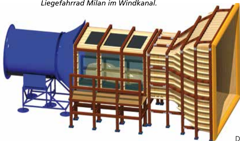
H.-U. Meier-Windkanal in der ersten Ausbaustufe (Offener Eiffel-Kanal).
