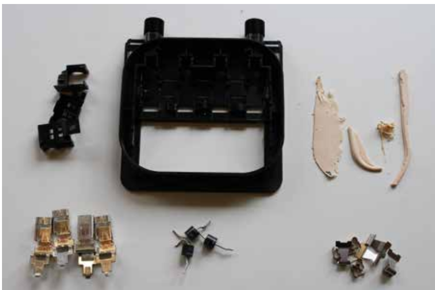
Demontierte Anschlussbox ohne Deckel (oben Mitte) mit (von oben links nach unten rechts) Klemmenabdeckung, Klebmasse als Befestigungsmasse an der Modulrückseite, Klemmen, Widerständen und Klemmblechen.
