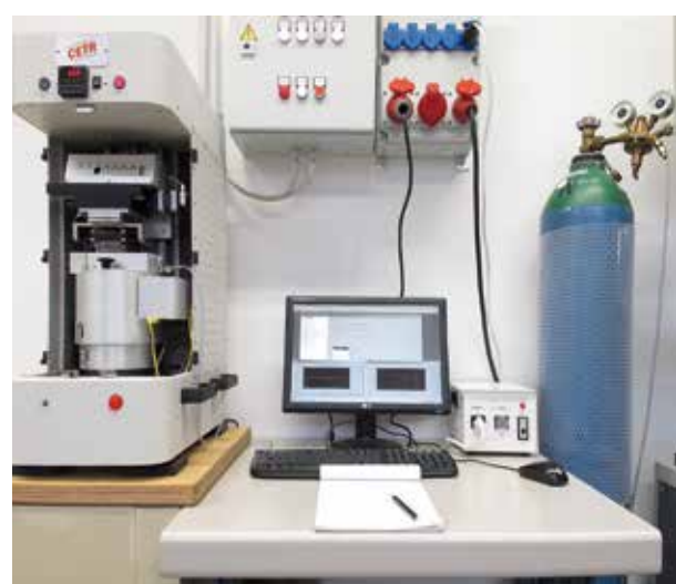
Typisches Testgerät für tribologische Tests unter Hochtemperatur: das Tribometer mit Peripherie.
