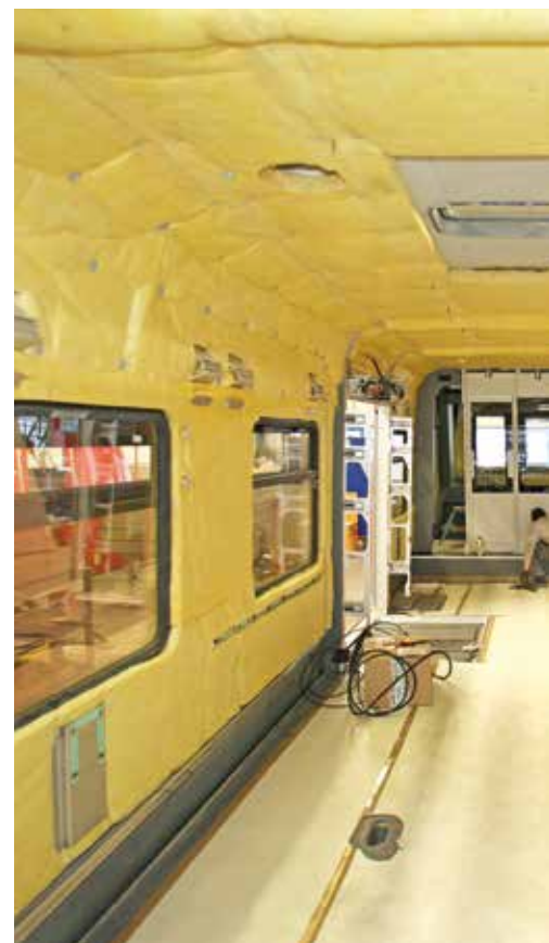
Innenausbau der DB-Baureihe 430, nachdem die Wärmeisolation angebracht wurde.
