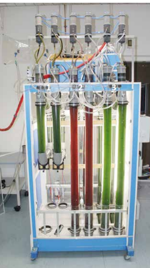
Airlift-Bioreaktor zur biogenen CO 2 -Anreicherung mit Parallelkulturen von Cyanobakterien (1), Rotalgen (2) und Grünalgen (3).
