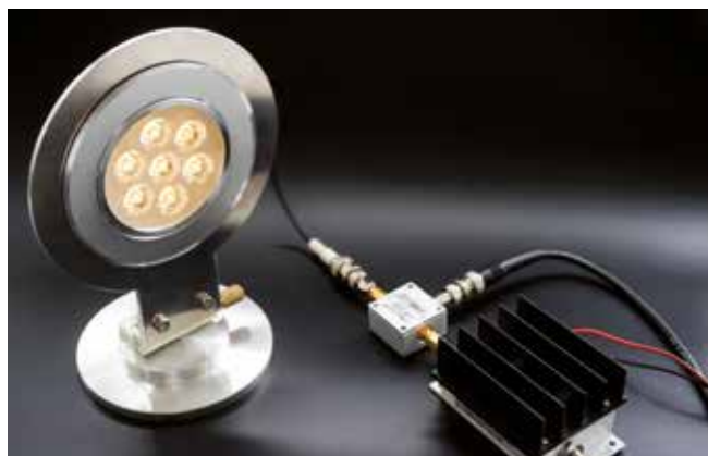
Sender und Empfänger: die LED-Deckenleuchte (links) als VLC-Quelle und der VLC-Messempfänger.
