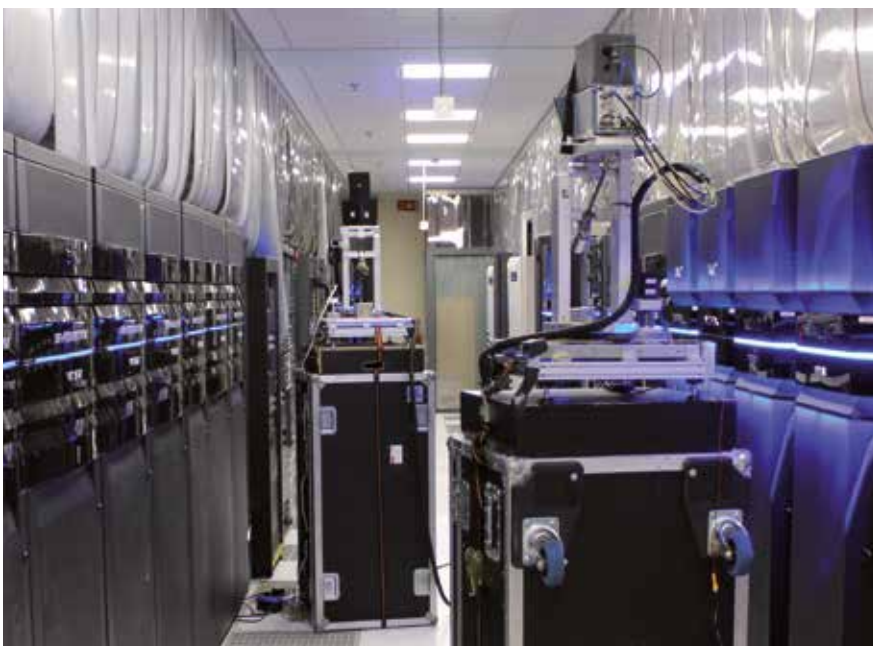
Ausbreitungsmessungen in einem Rechenzentrum bei 300 GHz mit dem Channel Sounder des Instituts für Nachrichtentechnik der TU Braunschweig.
