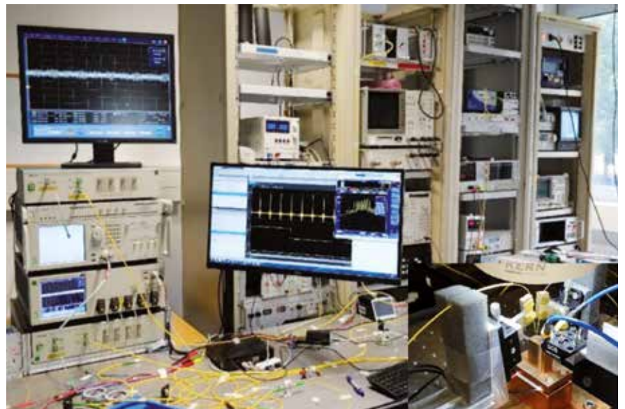
Messaufbau zur Charakterisierung von THz-Systemen bei der THz-Photonics Group der Technischen Universität Braunschweig. Das eingeschobene Bild unten rechts zeigt einen Aufbau zur Ansteuerung und Messung von integrierten elektronischen und photonischen Chips an der TU.
