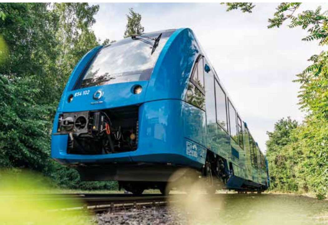
Der erste Personenzug, der mit einer Wasserstoff-Brennstoffzelle betrieben wird: der Coradia iLint von Alstom.
