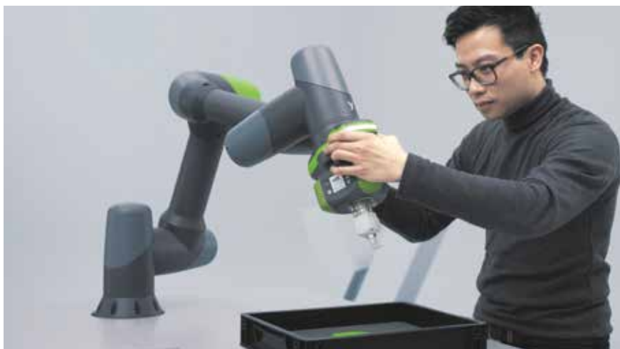
Die moderne Sensorik des Cobots sorgt für die geschickte Handhabung von Objekten – und die sichere Interaktion mit dem Menschen.
