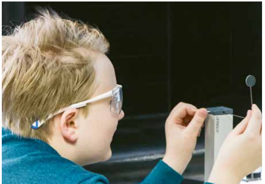
Im Windkanal des DLR_School_Lab können verschiedene Strömungskörper hinsichtlich ihres Strömungswiderstands vermessen werden.
