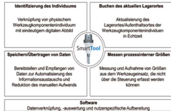
Bild 2: Modulare Funktionsbausteine des skalierbaren CPS „Smart Tool“
