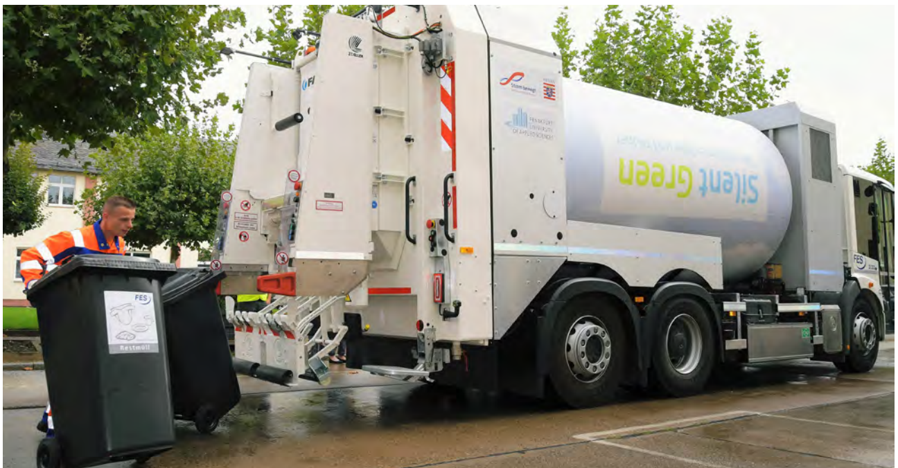
Bild 4: Prototyp des ersten erdgas-elektrisch angetriebenen Müllfahrzeugs (© Felix Wachendörfer, FES)
