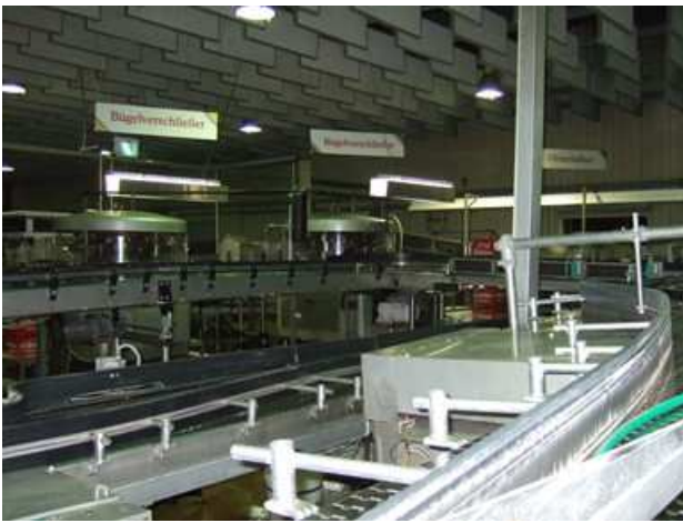
Halle, in der die Flaschen gereinigt, neu befüllt, etikettiert, verschlossen und versandfertig gemacht werden.
