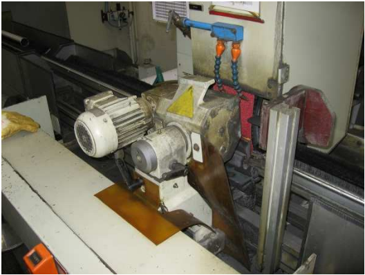
Abtragtest eines Schleifbandes
