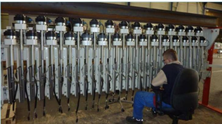
Endkontrolle eines Scalpers für 2,8 m breite MDF Platten
