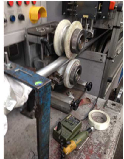
Das Rohr ist (fast) fertig, die gebogenen Enden werden jetzt zusammenschweißt.
