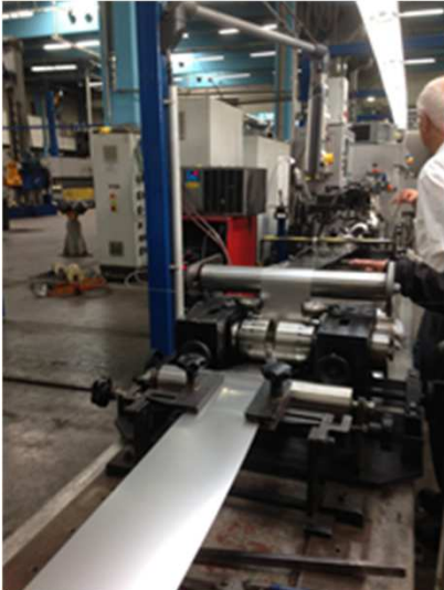
Edelstahlblech kommt von der Rolle, Ränder werden abgeschnitten.
