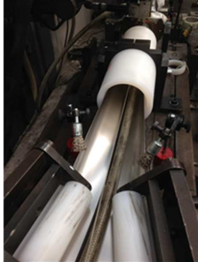
Das Blech wird zum Rohr gebogen
