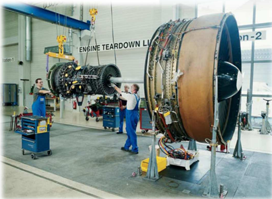
Demontage einer Turbine.
