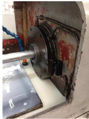
Das Rohr kommt in die Wellerscheibe (BRUGG Wellrohrtechnik) und erhält ein Gewinde
