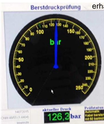
Max. Betriebsdruck des Rohrs 25 bar. Der Berstdruck von ca. 140 bar ist fast erreicht.
