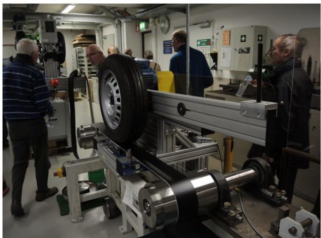
Beispiel einer Prüfung des beschichteten Bandes
