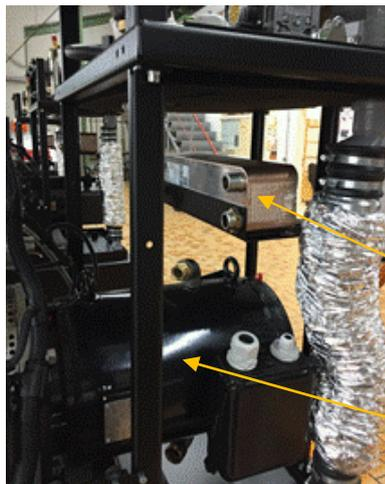
Herzstück ist ein mit Gas betriebener 4-Zylinder-Industrie- Ottomotor mit elektronischer Regelung. Ölwechsel und Nachfüllung erfolgt automatisch. Der Generator ist angeflanscht
