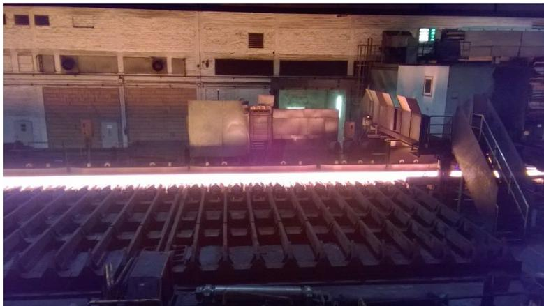
Walzstrasse: Hier wird aus der Bramme in mehreren Stufen Blech gewalzt
