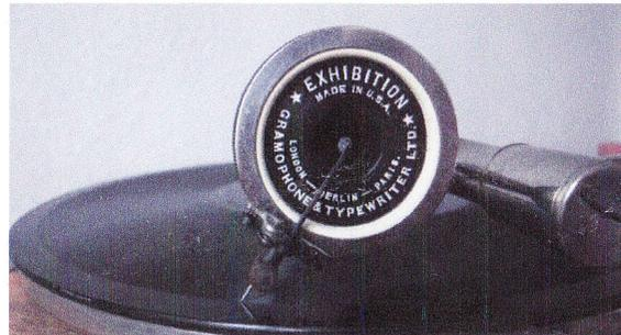
Schalldose Modell „Exhibition“ mit Stahlnadel beim Abtasten einer Schellackplatte • Bildquelle: S. Puille
