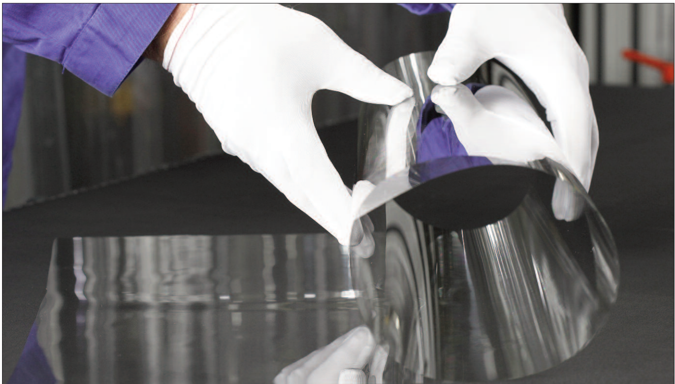
Das dünnste Glas der Welt – derzeit 25 Mikrometer Dicke – wird bei Schott in Grünenplan in einem kontinuierlichen Ziehverfahren hergestellt und auf Rollen gewickelt – für interessante Anwendungswelten. Foto: Schott Spezialglas
