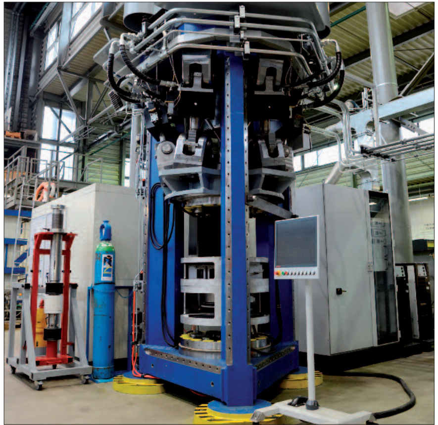
MagnetArc Schweißprototyp MIAB-VA230 zum Verschweißen von Casing-Rohrsegmenten. Foto: Helge Bauer
