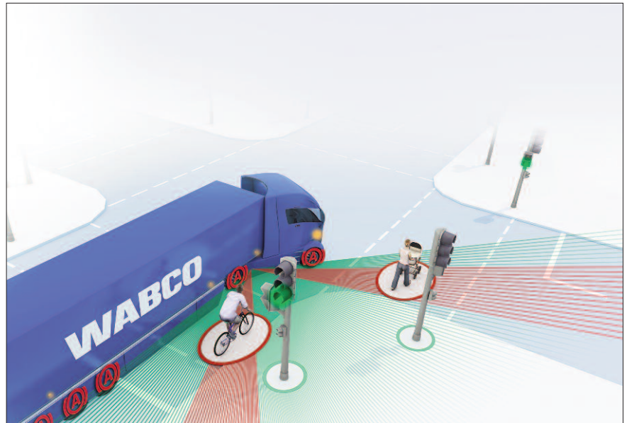
Wabcos OnCity Abbiegeassistent für den Stadtverkehr schützt Fußgänger und Radfahrer. Beim Abbiegen erkennt das System ungeschützte Verkehrsteilnehmer auf der Beifahrerseite. Es warnt den Fahrer und aktiviert automatisch die Bremsen des Nutzfahrzeugs. Grafik: Wabco
