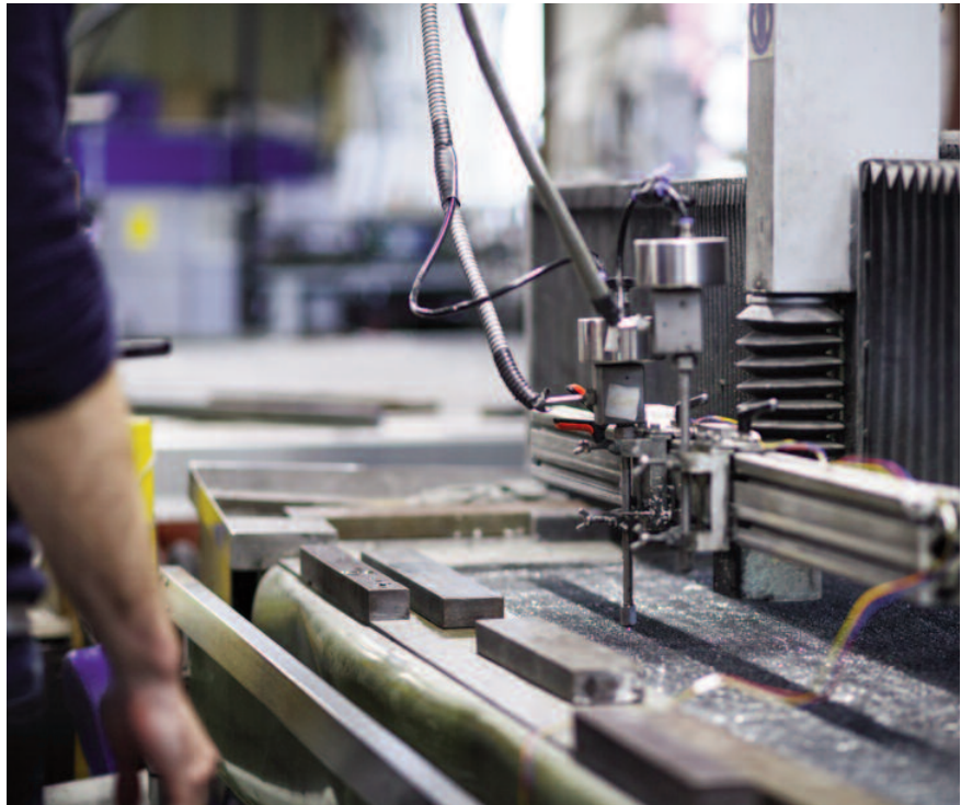
Diese Wasserstrahlanlage mit externer Sensorik hat Rehm an das Produktionssystem angebunden. Mittler bei dieser bezahlbaren Digitalisierungslösung war das Mittelstand 4.0-Kompetenzzentrum Hannover. Foto: Gerold Kuiper
