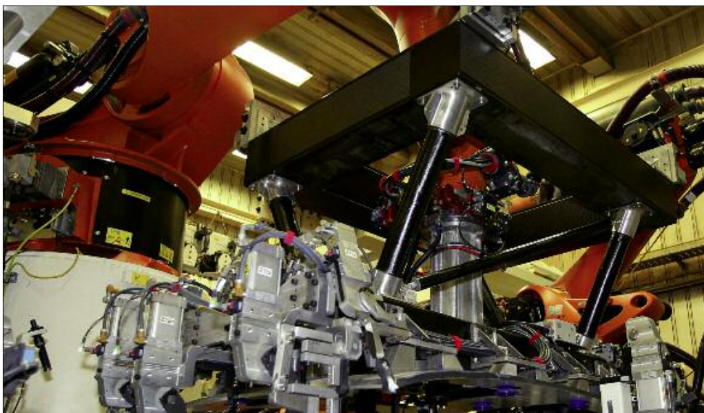
Der leichtere Dachgreifer optimiert die Karosseriefertigung im VW-Werk Wolfsburg.
