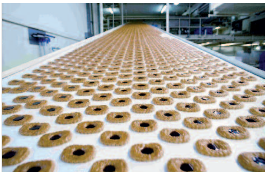
Siegling Transportbänder mit High Grip-Beschichtungen werden in der Lebensmittelindustrie beim Schrägtransport von Süßwaren eingesetzt.
