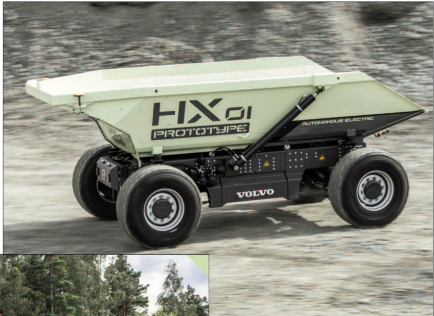
Kleiner Flitzer mit Zukunft: Der HX1 von Volvo CE ist ein autonomes von einer Elektrobatte angetriebenes Fahrzeug. Fotos (2): Volvo CE
