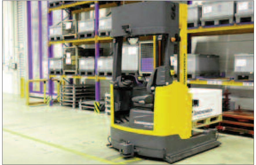
Das Fahrzeug kann sich frei durch Lager- und Produktionshallen bewegen – ohne Fahrer und vorgegebene Routen.
