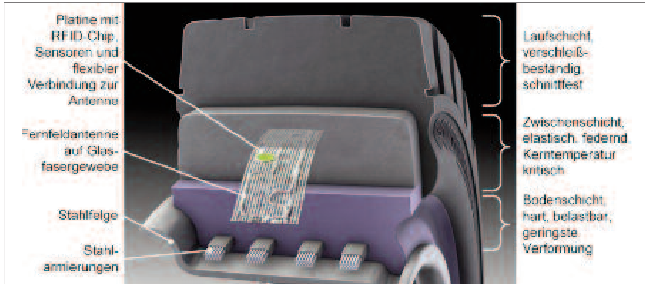
Schichtweiser Aufbau eines SE-Reifens mit Sensortransponder im temperaturkritischen Einbaubereich.
