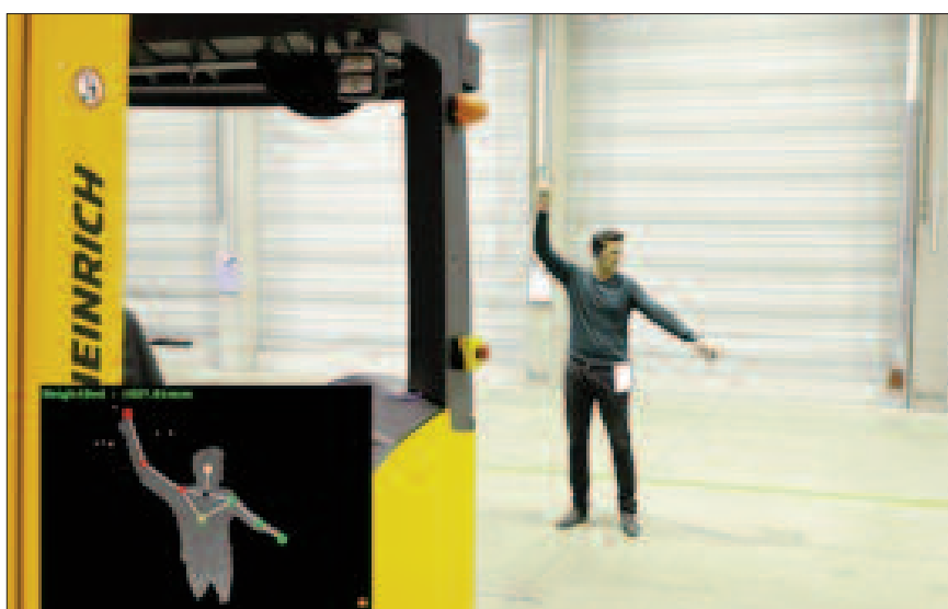
Gesteuert wird der Schubmaststapler über Sprache und Gesten: Die 3D-Kamera erkennt, wohin der Bediener zeigt.
