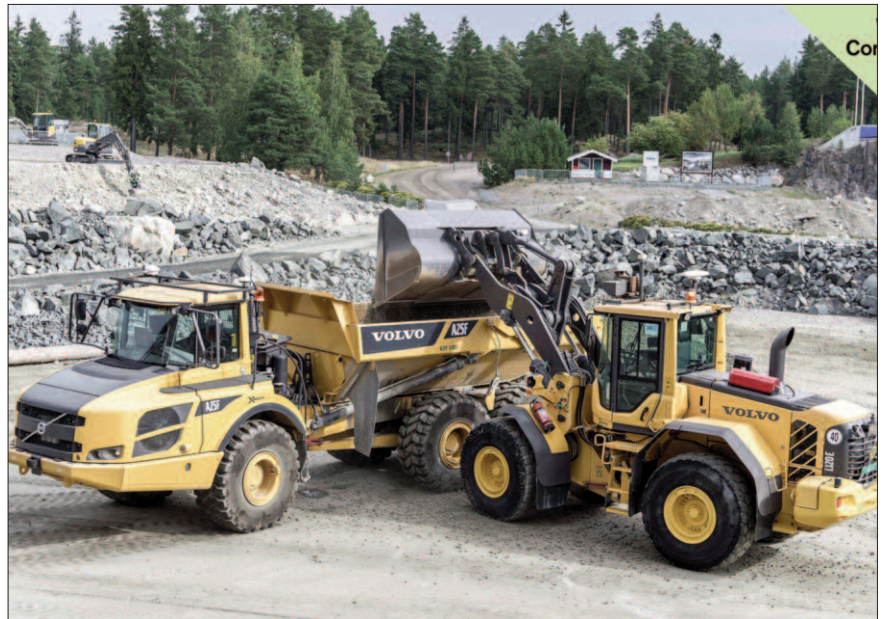
Programmierte Zusammenarbeit: Und am Ende bringen beide – der autonom knickgelenkte Dumper und der ihn beladende Radlader-Prototyp – 70 Prozent der Leistung menschlicher Bediener. Foto: Volvo Construction Equipment
