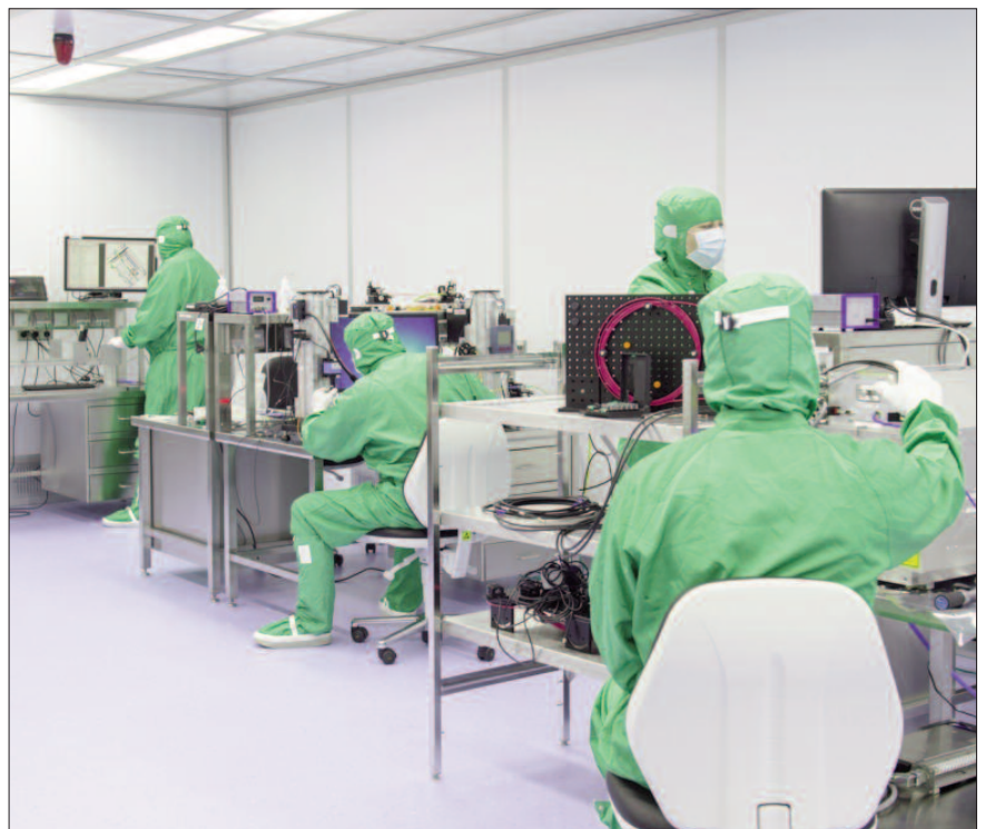
In dem vorhandenen Reinraum der ISO-Klasse 6 werden Halbleiter für optische Komponenten gemessen, montiert und später verpackt. Foto: Qioptiq
