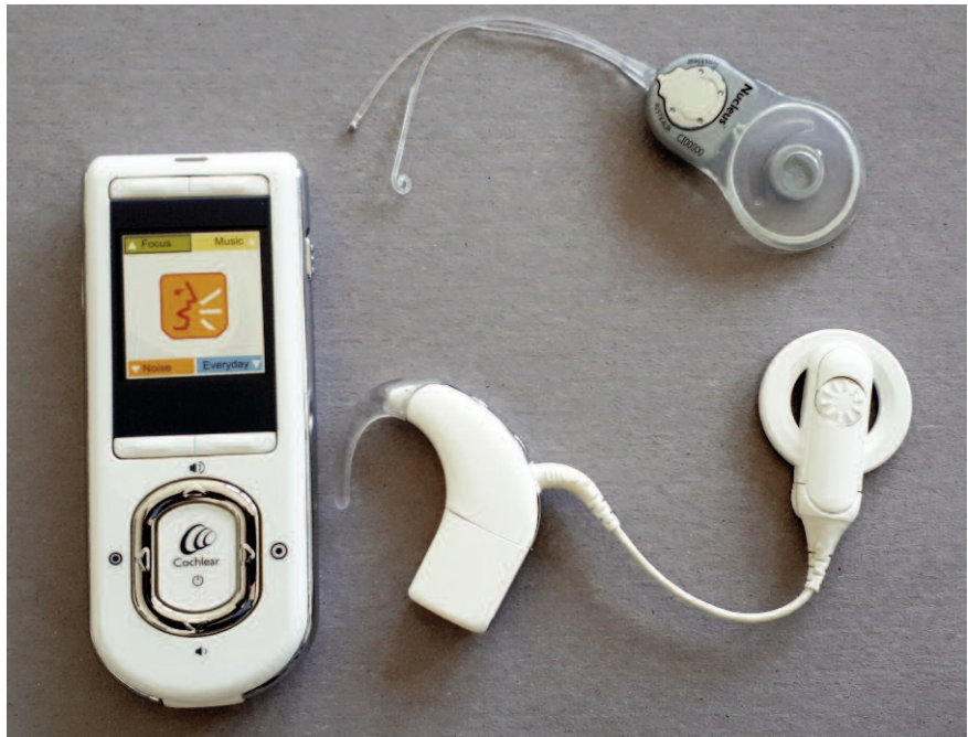
Hörgerät, Cochlea-Implantat zum Anschluss an die Hörschnecke und Programmiergerät für das Gesamtsystem.
