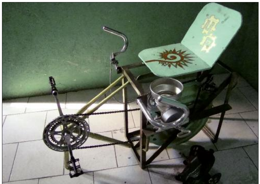
Eine Fahrradmühle bringt das Mahlwerk über einen Radantrieb in Schwung.
