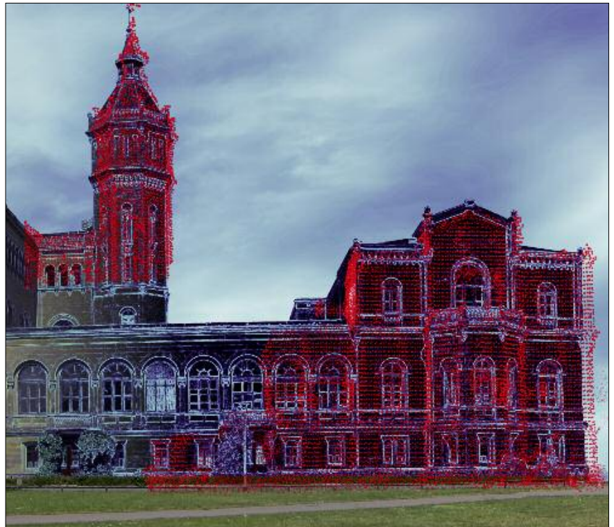
Gebäude – wie hier die Leibniz Universität in Hannover – werden im Detail modelliert, damit errechnet werden kann, wie groß der Wärmeverlust ist oder ob sich das Anbringen von Sonnenkollektoren lohnt. Modell: Tobias Dahinden
