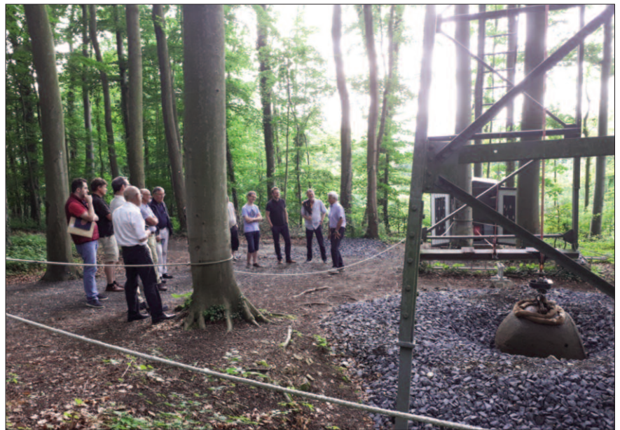
Mit dem Fall der vier Tonnen schweren Minitrop-Kugel können Mini-Erdbeben künstlich ausgelöst werden. Fotos: Eva Knappe
