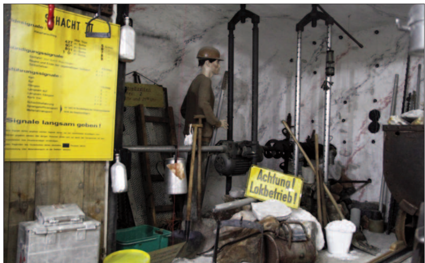
Nachbildung eines Arbeitsorts zur Salzgewinnung untertage mit Bohrmaschinen und Förderwagen.
