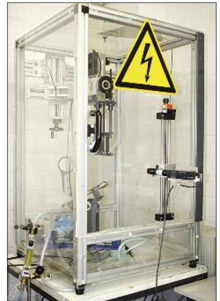
Elektrosinninganlage zur Fertigung von Herzklappengerüsten. Bild: Institut für Mehrphasenprozesse, LUH
