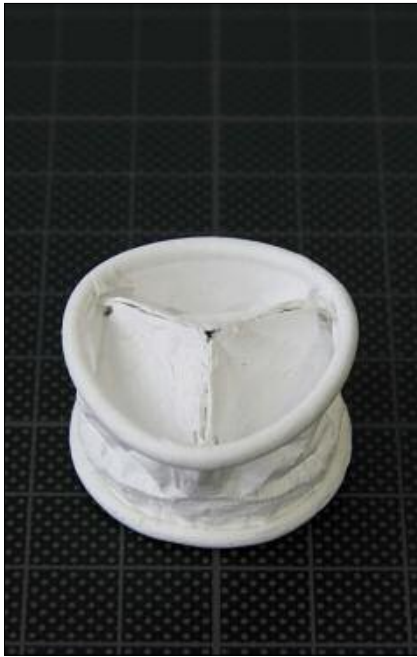
Elektrogesponnenes Gerüst in Form einer Herzklappe.
