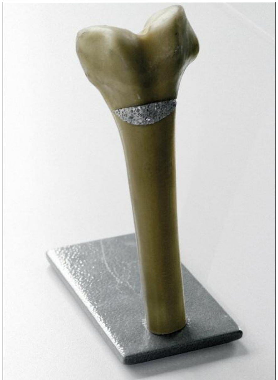
Ein Schaum aus Magnesium könnte künftig Lücken in zertrümmerten Knochen schließen. Bild: Institut für Werkstoffkunde, Leibniz Universität Hannover (LUH)
