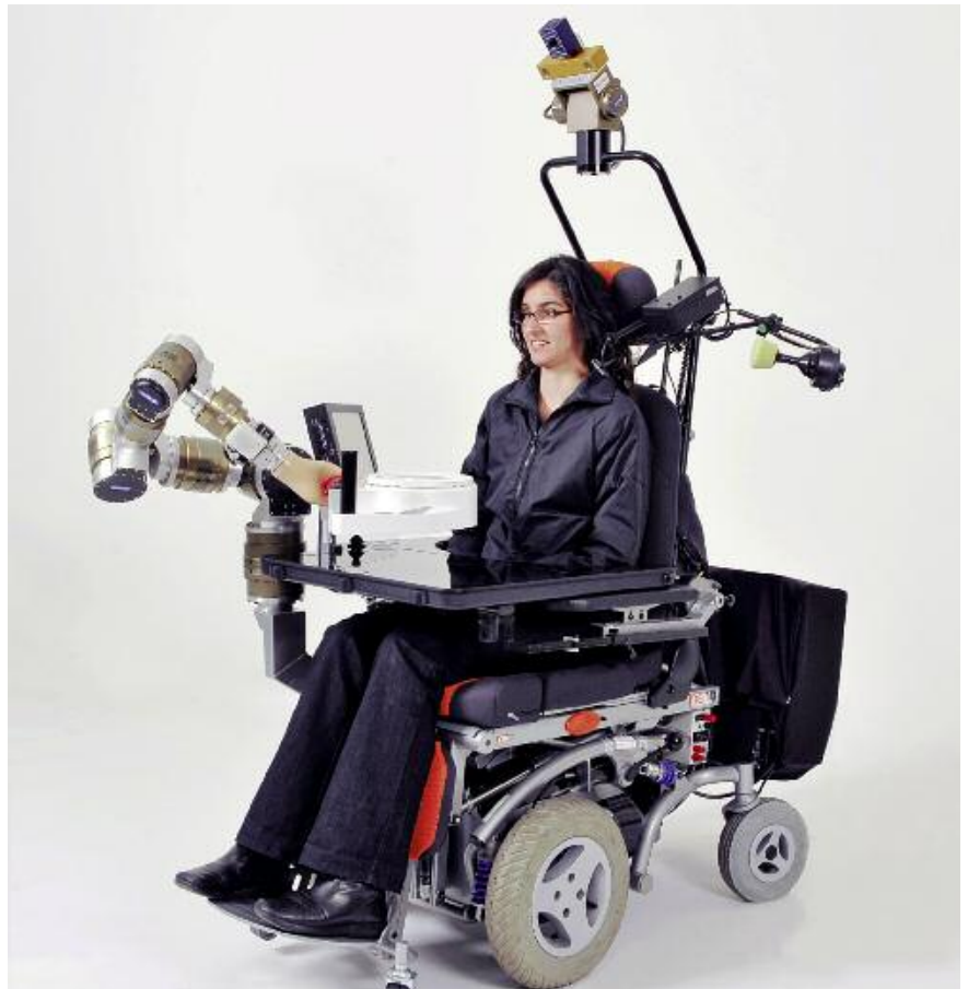
Der intelligente Assistenzroboter Friend soll Schwerbehinderten zu mehr Autonomie im Alltag verhelfen.
