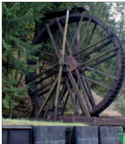
Wasserrad zur Inbetriebhaltung der Fahrkunst im Silberbergbau.
