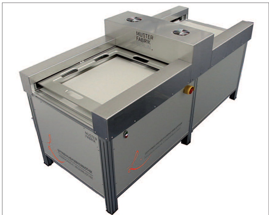
Der von der Berliner MusterFabrik eigens entwickelte Scanner zur digitalen Rekonstruktion der Leibniz-Textfragmente.
