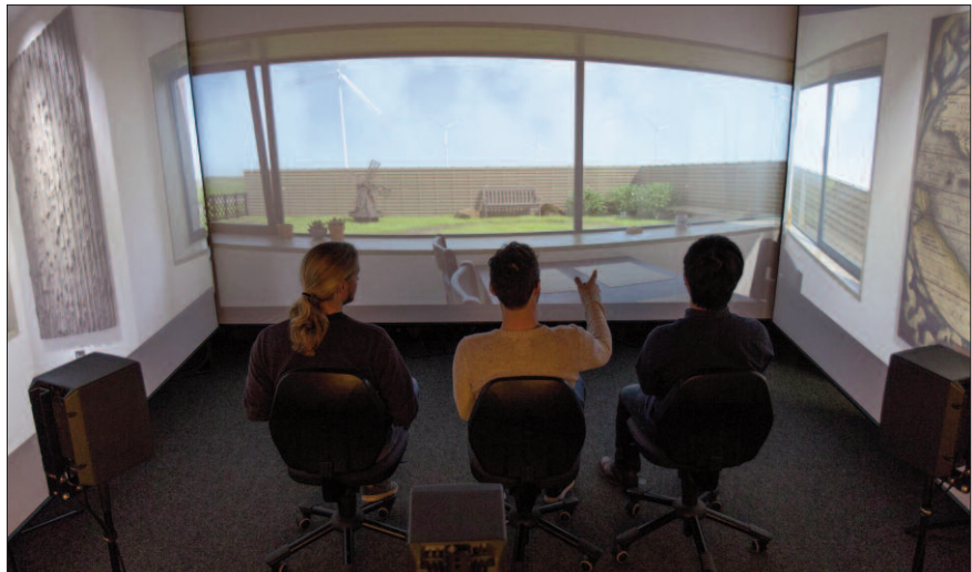
Visuelle und akustische Simulation von Windenergieanlagen in einem Gebäude. Quelle: IKT der Leibniz Universität Hannover
