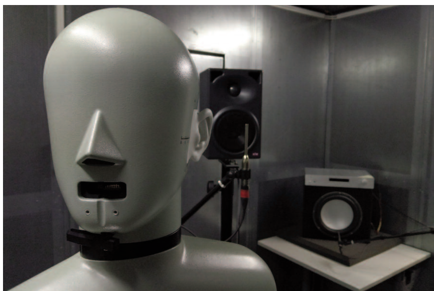
An einem Kunstkopf wird die Lärmreduktion gemessen.
