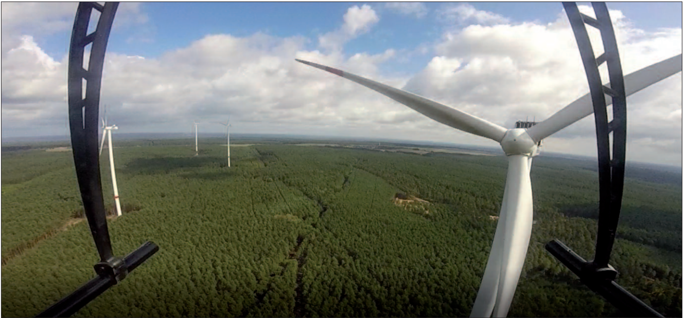
Oktokepler während eines Messflugs vor vier Windenergieanlagen. Foto: Physikalisch-technische Bundesanstalt (PTB)
