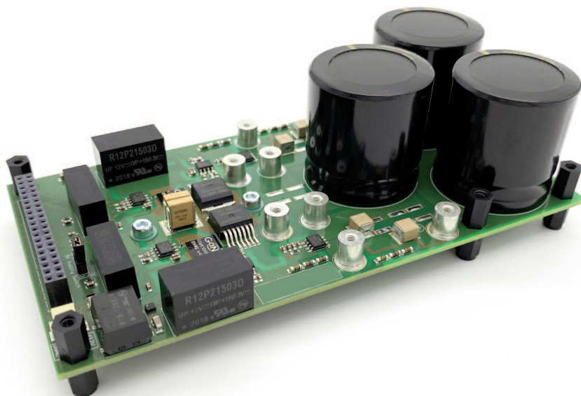
Leitungsplatine eines Einphasen-Modulwechselrichters. Foto: IAL der LUH
