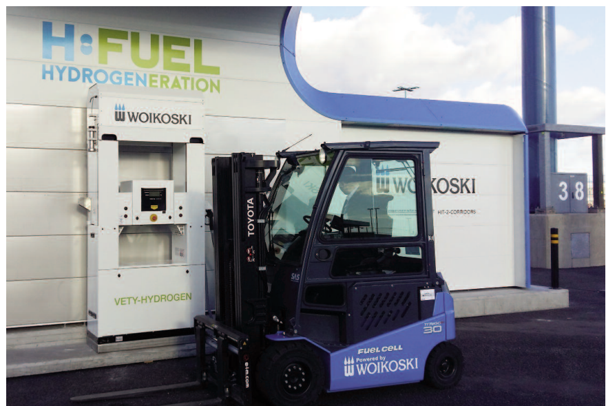
Noch ist das ungewöhnlich in der Region: Ein Gabelstapler wird an einer Wassertankstelle mit neuer Energie versorgt.
