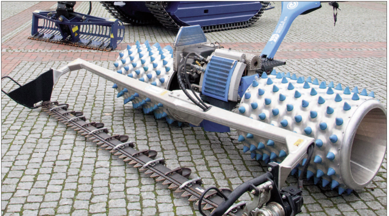
Gut für die Torfmoosernte geeignet sind Einachsschlepper von Brielmaier mit patentierten Stachelwalzen und großer Aufstandsfläche. Fotos (2): 3N Kompetenzzentrum
