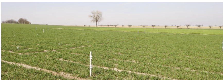
Die Mikroklimasensoren von Agvolution senden Daten vom Feld an eine Basisstation. Foto: Agvolution
