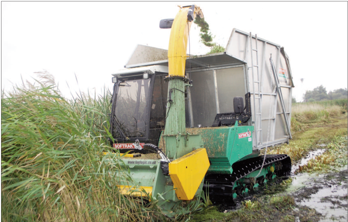
Dieser Softrak 120-Häcksler von Loglogic erntet die Biomasse sauber ab.
