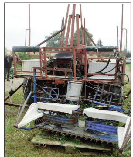
Radbasierte Saiga-Maschinen eignen sich ganz hervorragend für die Reet-Ernte.
