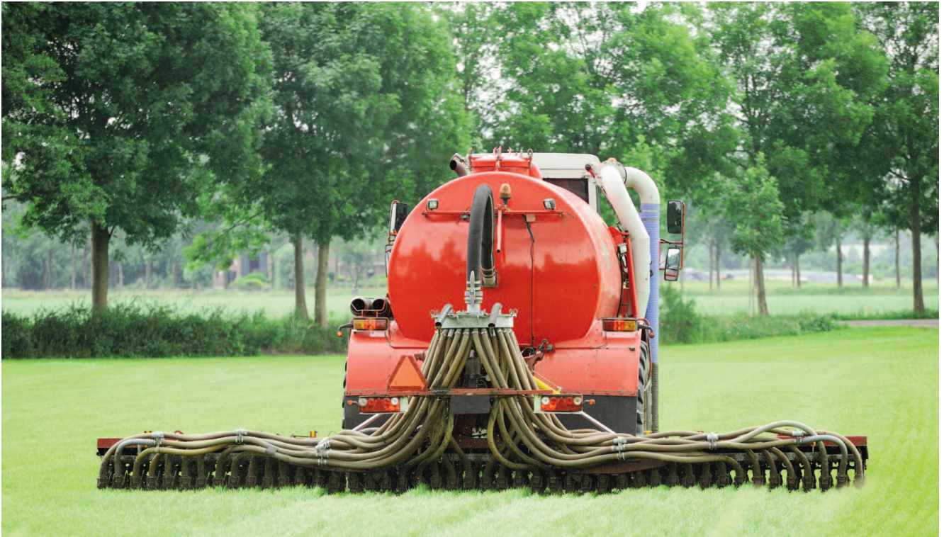
Bodennahe Ausbringung von Wirtschaftsdünger auf Grünland mit automatisiertem Lenksystem.
