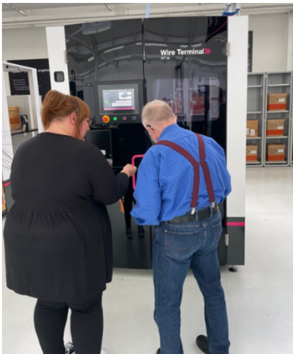
Am Wire Terminal : Erstellung von komplett konfektionierten Verdrahtungskabeln inkl. Endhülsen auf der Basis der mit Eplan Software vorgeplanten Bestückung eines Schaltschranks
