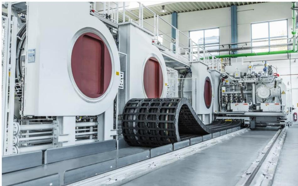
Automatisierte Bestückung der Härteanlagen (Foto: Wegener Härtetechnik GmbH)
