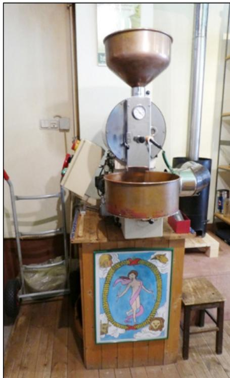
Abbildung 1: Röstapparatur, Fassungsvermögen 1,5 kg
