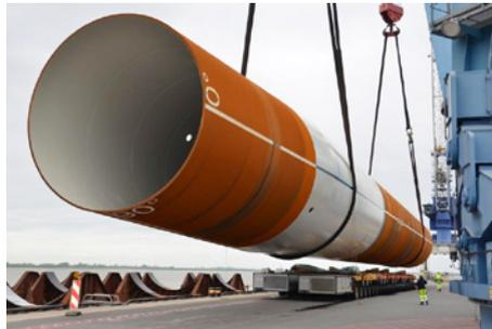
Monopiles für Offshore-Windkraftanlagen haben aktuell bis zu zehn Meter Durchmesser und 1.500 Tonnen Gewicht. Materialforscher der Universität des Saarlandes und Maschinenbauer der RWTH Aachen wollen dafür gemeinsam mit dem Stahlspezialisten Dillinger und weiteren Firmen maßgeschneiderte neue Stahlsorten entwickeln. (Foto: UdS)
