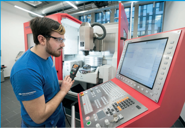
Prozesse werden mit hoch technologischen Maschinen gesteuert: Auszubildende erstellen Programme für computergesteuerte Fertigungseinrichtungen, programmieren und bedienen Anlagen. Foto: Freudenberg Gruppe
