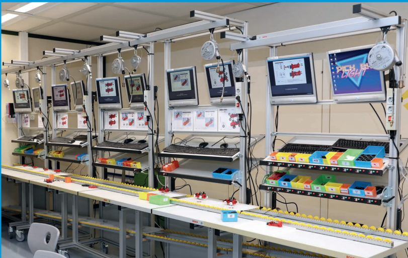
Montagelinie mit Pick-by-Light System. (Foto: Ronald Neesse)
