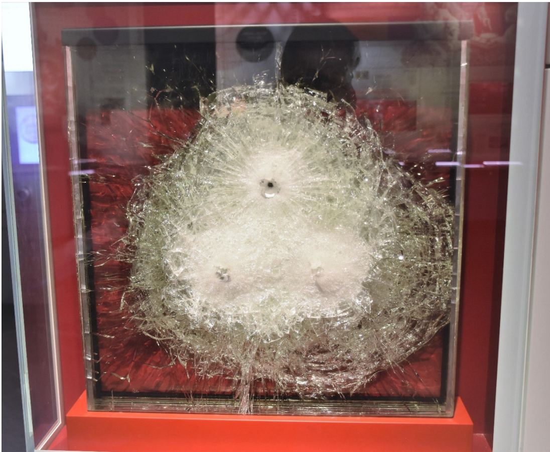
Oben: Modell eines Geldtransporters Unten: Panzerglasscheibe nach Schusstests
