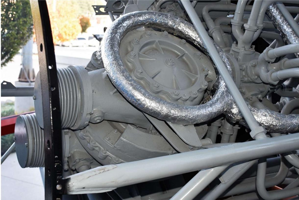
Turbopumpe der A4/V2-Rakete eingebaut (hergestellt von KSB Frankenthal/Pfalz)
