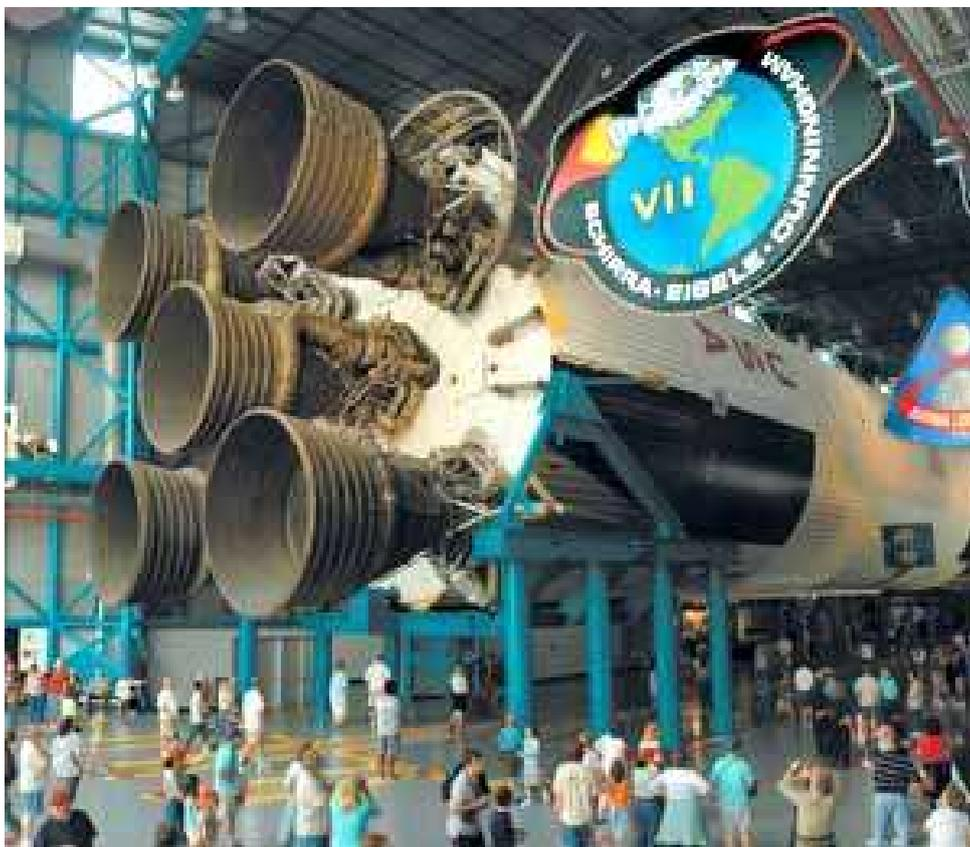
F1-Triebwerke der Saturn V-Rakete [Quelle: KSC]
