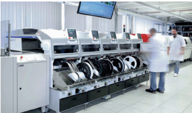
SMD-Bestückung von Leiterplatten in Wiesbaden
