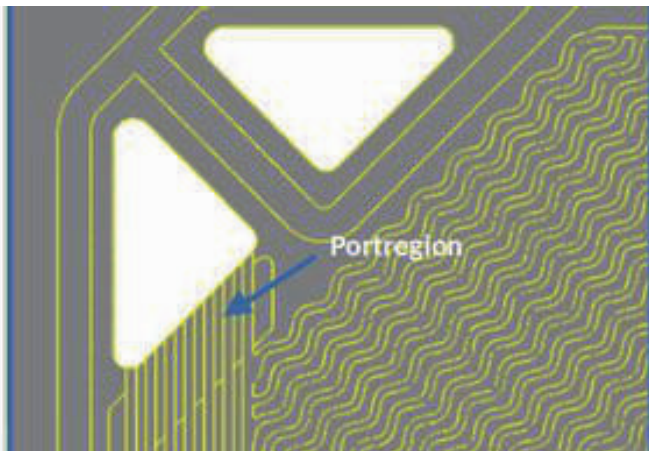
Ausschnitt einer Bipolarplatte mit Reaktandenkanäle und der Portregion. Der weiße Ausschnitt ist der Header.
