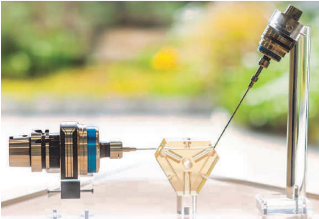
Bearbeitungssituation bei Einsatz der Schleifwerkzeuge an einem Gyroskopkörper aus Zerodur®
